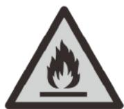
При эксплуатации, обслуживании и утилизации прибора обратите внимание на данный символ, который расположен на задней части прибора (на задней панели или на компрессоре) и имеет желтый или оранжевый цвет. Это предупреждающий символ опасности возгорания. В трубах хладагента и компрессоре имеются легковоспламеняющиеся материалы.
