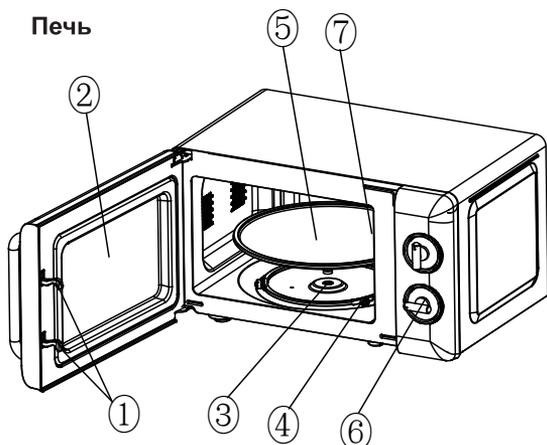
1. Фиксаторы блокировки дверцы
