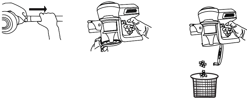
Рис. 10. Порядок быстрой очистки контейнера - пылесборника
