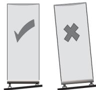
Если пол в месте установки не выровнен, то следует установить холодильник по уровню, невзирая на то, что плоскость дна холодильника не будет параллельна плоскости пола.
